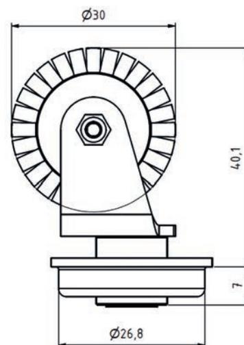
Składa się z łożyska kulkowego i wstępnie zmontowanej rolki transportowej
